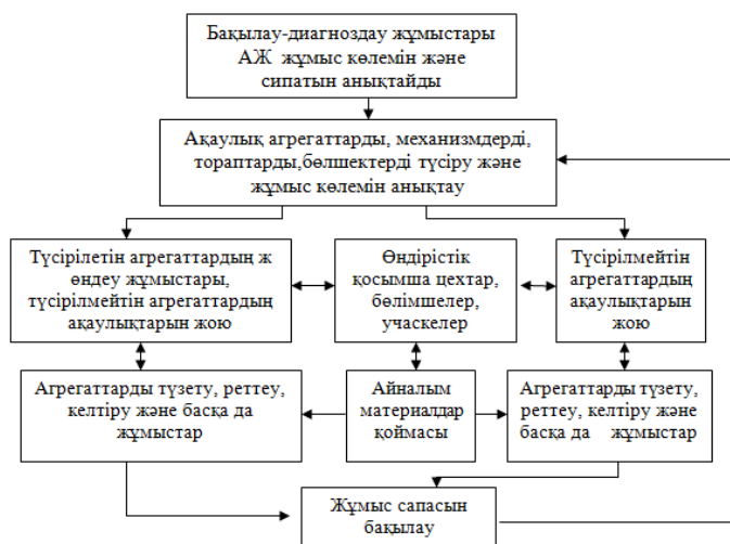
6-Сурет – Автокөліктің ағымды жөндеу барысының сұлбесі
